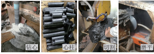
图 1 试件加工过程
