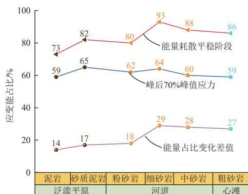
图 9 不同沉积环境的岩石峰后 70% 峰值应力弹性能变化
