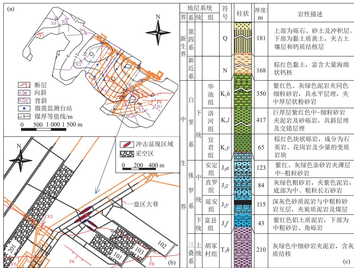
图 1 高家堡煤矿采掘工程布置及地层综合柱状图
