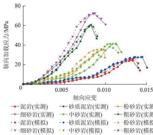
图 7 不同沉积环境的岩石单轴压缩条件下的应力-应变曲线和数值结果对比
