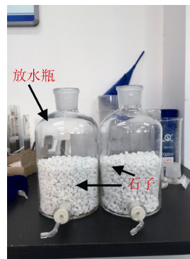
图 2 抗渗性测试装置
