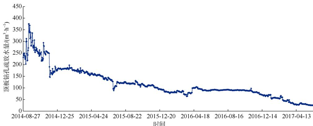
图 5 顶板疏放水量变化曲线
